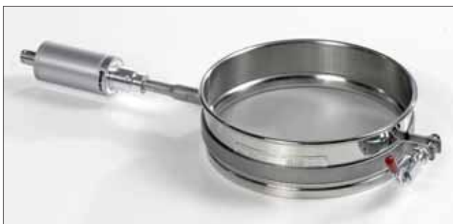
Excitation de tamis verticale et latérale via la variation de fréquence ARTECH
